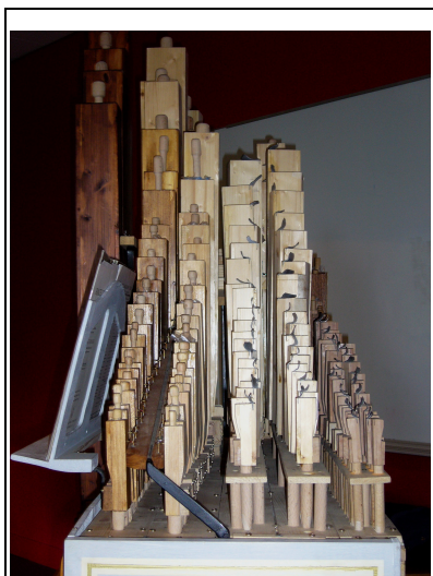
A gauche, un jeu de bourdons, au centre une flûte de 4' et à droite, un jeu de doublette 2'.
